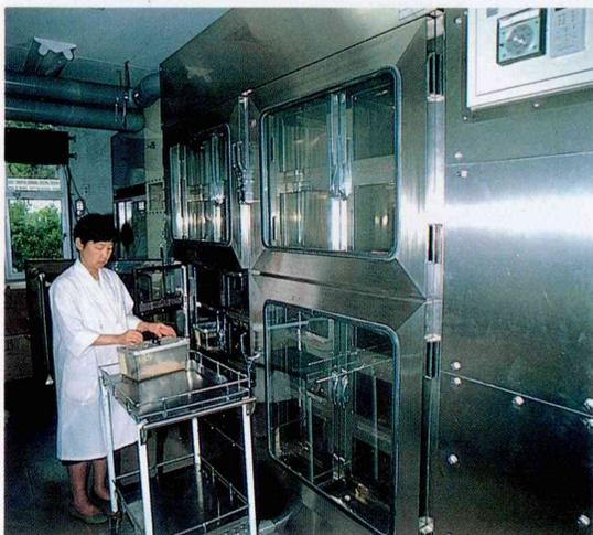
隔離ネズミ処理装置
