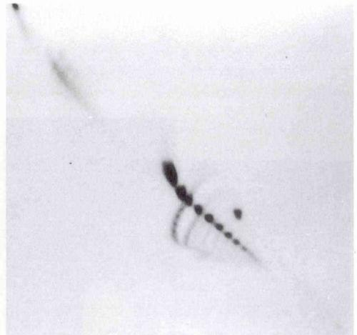
複雑な高次構造をもつ立体異性体DNAの2次元電気泳動による分離。DNAの高次構造は真核生物の遺伝子発現制御に重要な役割を果している。
