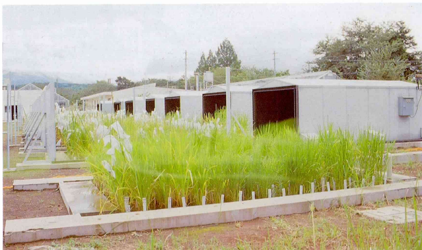
日長処理装置 野生イネの多くは、短日条件下で花芽が分化する性質をもつので、日本のような高緯度地方では開花結実しない。日長処理装置は日長を自動的に調節して短日植物の開花を制御するための装置であって、野生イネ用開いた遺伝実験や遺伝資源の保存のために重要である。
