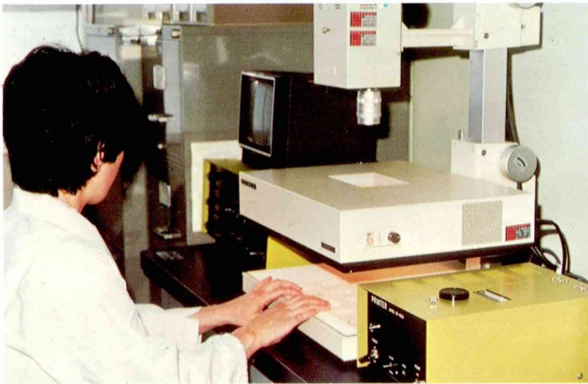
▲自動蚕卵計測装置によるカイコの卵色突然変異の検出
