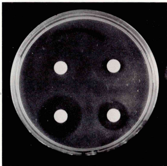
▼ 枯草菌孢子によるDNA傷害の検出 ラット肝ミクロソームによって活性化されたTrp-P（トリプトファン燃焼物）による生育阻害
